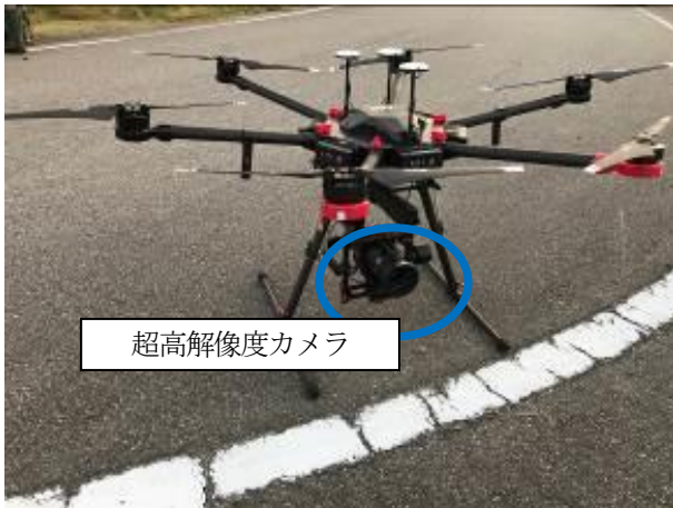
Fig. 6 UAVに搭載した超高解像度カメラ
