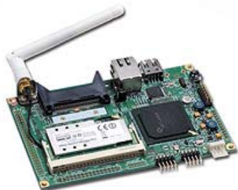
Photo1 ユニット試作機に組み込む Armadillo-300
